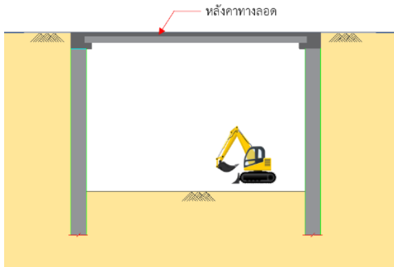
รูปที่ 8-6 ขั้นตอนที่ 3 การก่อสร้างโครงสร้างหลังคาทางลอด ในพื้นที่ก่อสร้าง ระยะที่ 2
